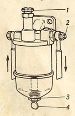
Pig. 1. Roto-diesel sediment bulb:
